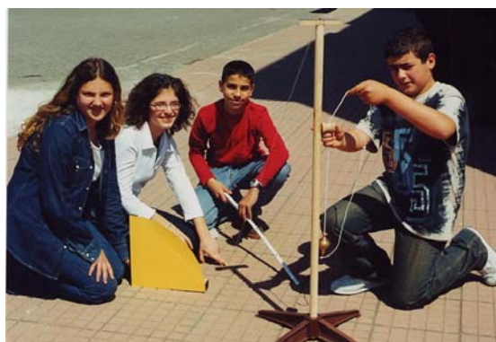
fig.6 Misurazione diretta con corda e goniometro di cartone degli alunni della S.M.S. "Caloprese" di Scalea (G.Castelli).
