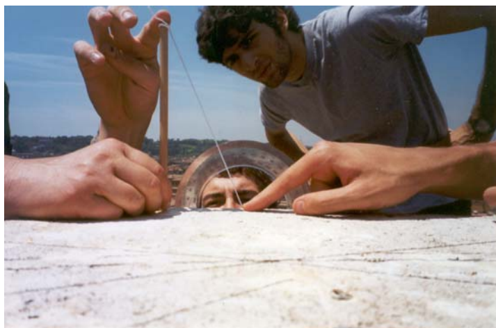
fig.5 Misura diretta dell'altezza del sole (L.Corbo)
