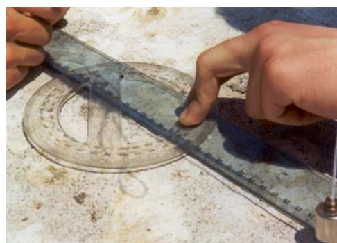
fig. 8 Orientamento del goniometro sulla linea d'ombra (L.Corbo)
