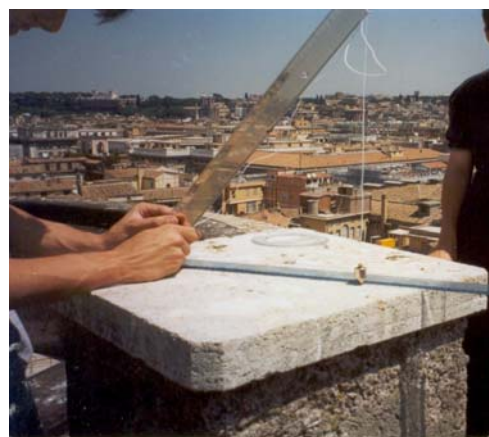
fig.7 Traccia dell'ombra di un filo a piombo sopra un pilastrino della Chiesa S. Ignazio - Roma (L.Corbo)
